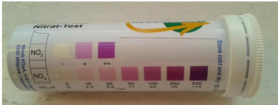
**/> Nitrites** : La bandelette réactive est constituée de 2 zones réactives. Celle du bas, est celle qui réagit aux nitrates ( $\text{NO}_3^-$ ). Celle située juste au-dessus, réagit aux nitrites ( $\text{NO}_2^-$ ). L'apparition de nitrites dans votre sol peut être le signe d'un engorgement en eau ou de tassemement de sol.
